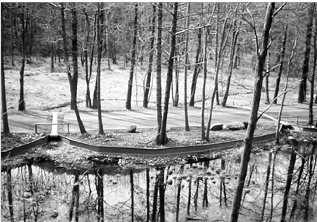
Solide Dauerabschrankungen mit grossen Kleintierdurchlässen bilden eine mögliche Lösung, um den Massentod wandernder Amphibien auf der Strasse zu verhindern.
